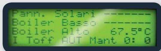
Lectura de las sondas de temperatura de los paneles solares y de los puntos bajo y alto del acumulador inercial o depósito de ACS.
