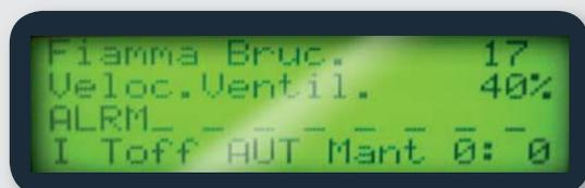
Visualización de la intensidad de la llama del quemador sobre una escala de 0 a 255, de la velocidad del ventilador y del estado de las alarmas.
